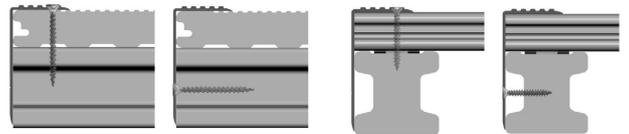
Les deux options de vissage sont possibles : vissage par le dessus ou vissage par le côté
